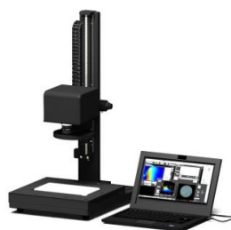
レンズ金型の形状データからの面粗さ評価
