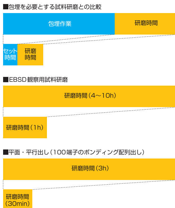
【作業時間の比較】(上段:従来の研磨機 下段:ISPP-1000)
